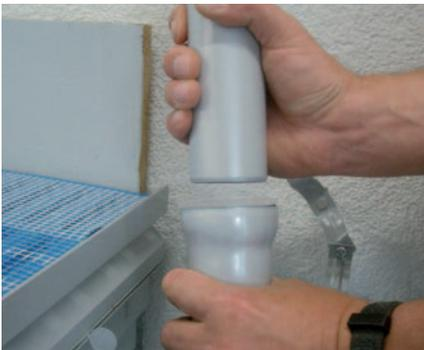
Die Komponenten des ProRin® AL Fallrohrsystems werden einfach ineinander gesteckt. Ohne Löten, ohne Kleben, ohne Schrauben. Die Dichtigkeit wird durch die integrierte ProRin® AL Dichtmanschette gewährleistet.
